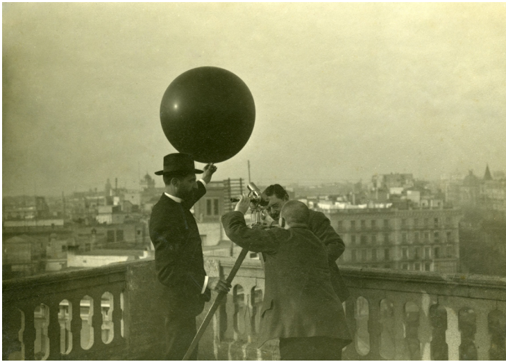
Llançament d'un globus sonda des del terrat de la Reial Acadèmia de les Ciències i les Arts de Barcelona, al voltant de 1914. Font: Arxiu Fotogràfic de Barcelona.
