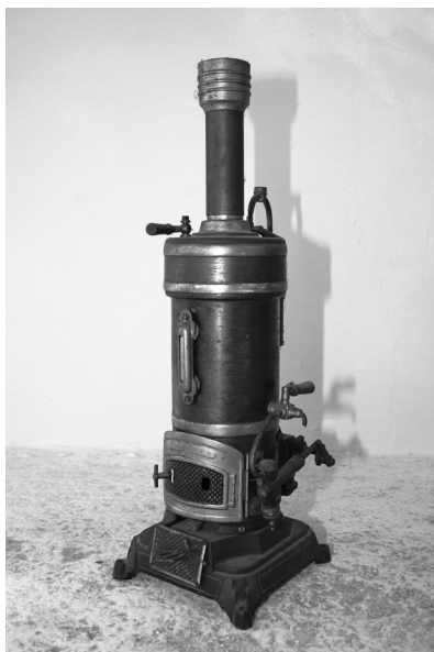
Petita màquina de vapor alimentada per alcohol que Celestí Bellera va construir amb ajuda d'un ferrer per ensenyar als alumnes de les escoles de Palou la generació d'energia. Fotografia: Ricard Bellera Kirchoff.
