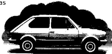
Parachoques de resina elástica, que incorporan las luces de posición. Mayor superficie acristalada, con lo que se aumenta la visibilidad interior y cristales posteriores practicables. Molduras laterales de goma para proteger la carrocería. Nuevo sistema de válvulas de aireación. Mejor acceso al maletero. Todo para lograr una línea más estética
