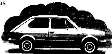
Parachoques de resina elástica, que incorporan las luces de posición. Mayor superficie acristalada, con lo que se aumenta la visibilidad y luminosidad interior y cristales posteriores practicables. Molduras laterales de goma para proteger la carrocería. Nuevo sistema de válvulas de aireación. Mejor acceso al maletero. Todo para lograr una línea más estética
