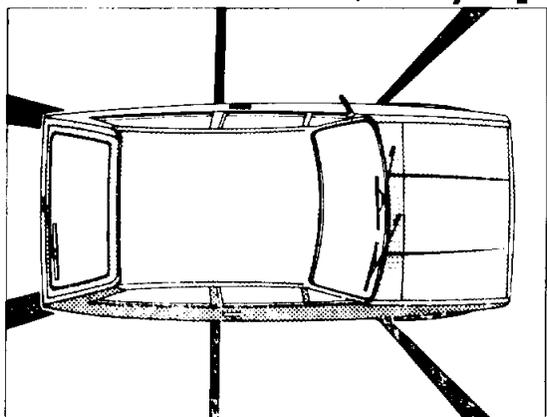
Una carrocería hecha con chapa de primera calidad permite que las columnas de ventanas y parabrisas sean más delgadas, siendo igual de fuertes. Lo cual permite hacer un parabrisas más amplio y envolvente, unas ventanas laterales con más superficie y conseguir una visibilidad
