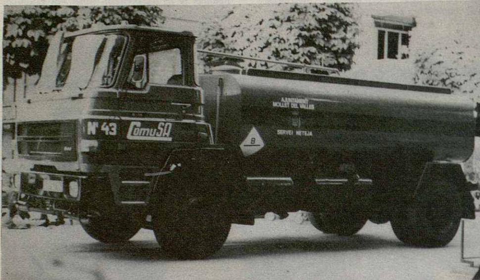
Camió cuba, con capacidad para 9.000 litros, destinados al riego, baldeo y una boca de riego a presión para limpieza.
