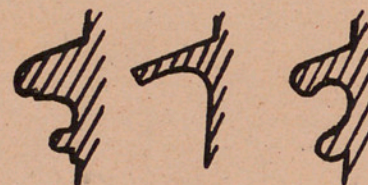
Figs. 2, 3 y 4. — Molduras góticas de la Torre.
