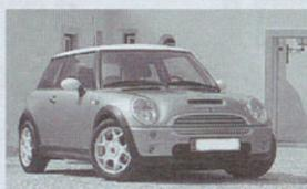
La base mecánica es la misma que la del One y el Cooper, pero sobrealimentada, lo que ha obligado a modificar el diseño de la carrocería en su parte frontal. Por eso, aparece la protuberancia del capó delantero, que aloja una generosa entrada de aire para la refrigeración del "intercooler" del compresor. Al mismo tiempo, se ha optimizado la ae-
